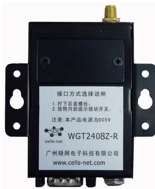
图 1-2 WGT2408Z-R 背面（标准出货有款压 6-24V 版本）
